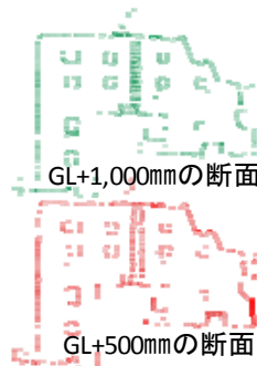
図7 点群から作成した断面図
