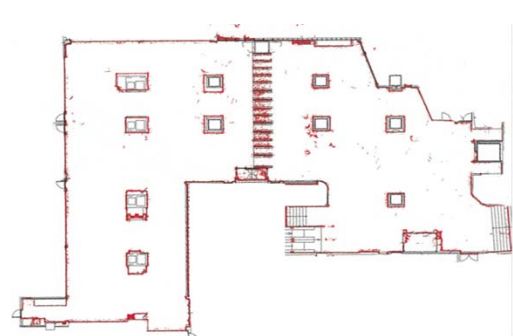
図8 断面図と既存平面図の整合状況
