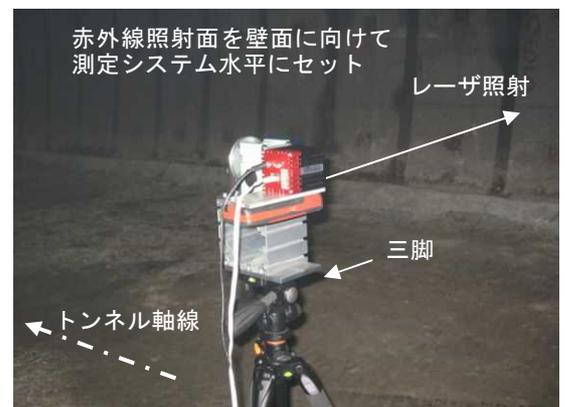
写真-2 実験状況 (トンネル内の設置状況)
