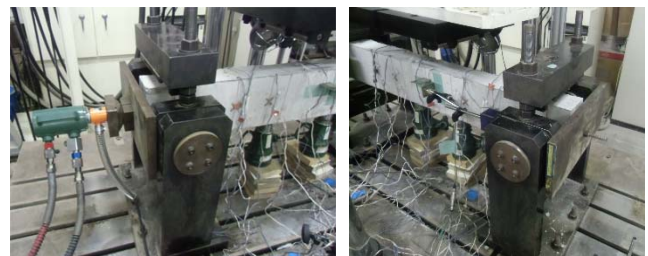
写真-1 軸方向引張力の導入状況
