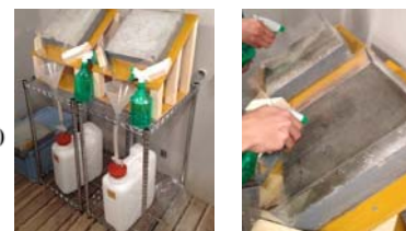
図-2 供試体の設置および散水
