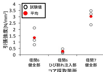
図6 引張試験結果
