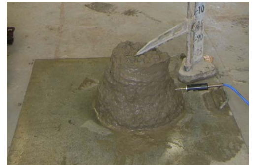
写真-3 スランプ試験状況(24-12-20N)
