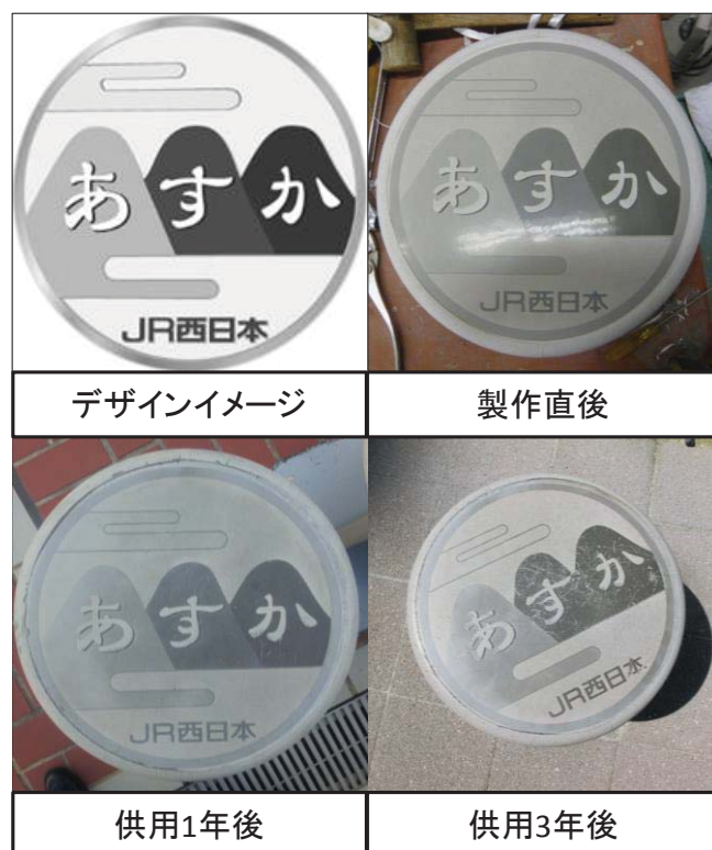
図4 コンクリート製椅子表面の様子
