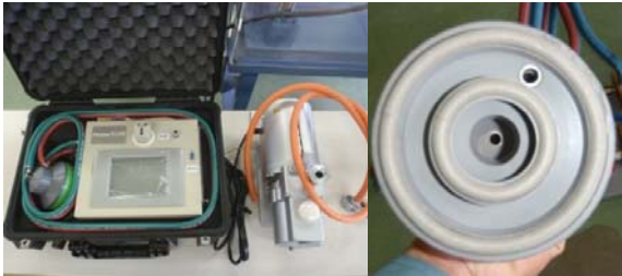
写真-1 表層透気試験機
