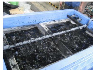
写真-1 逆流洗浄の実施状況
