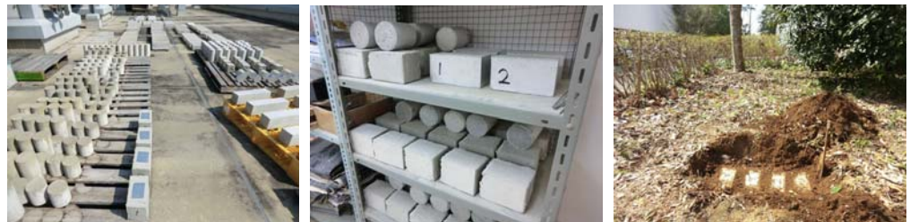
(A)屋外(※両試験面を南北に向け設置) (B)室内 (※実験室内の状況) (C)土中 (※発掘回収時の状況)
