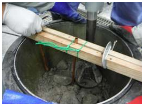
写真-1 断熱温度上昇量測定容器への試料締め
