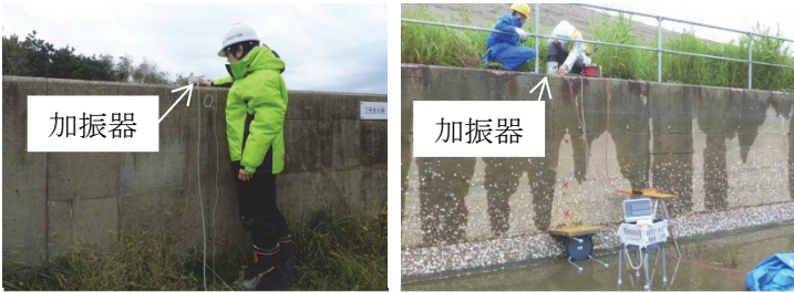
写真-1 水路の現場試験
