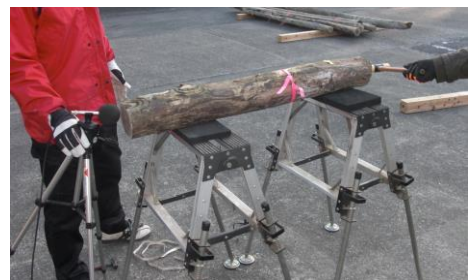
写真-3 打撃音法実施状況
