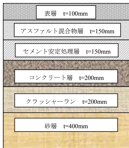
図 2 既設の舗装構成
