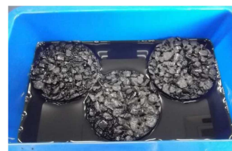
写真-1 溶剤浸水状況
