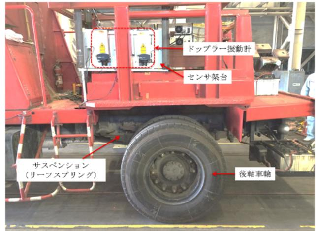
図-1 载荷用車両に設置したドップラー振動計
