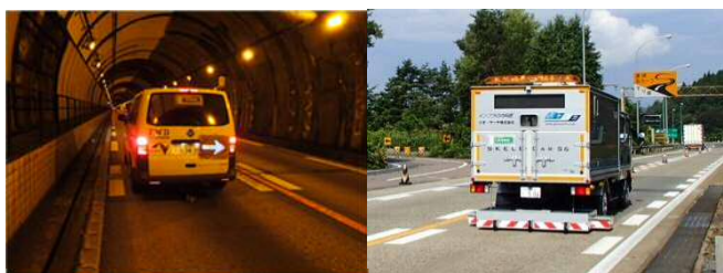
写真-1 FWD 測定状況
