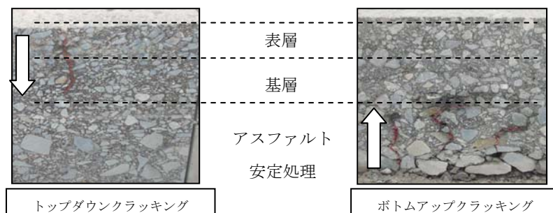
図-3 舗装の損傷要因
