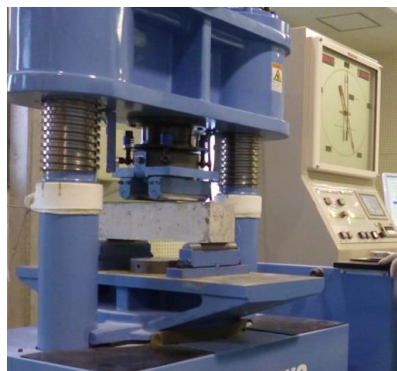
図 2 曲げ試験状況
