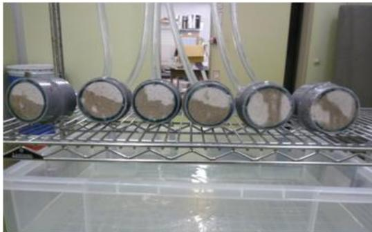
図.3 透水試験状況
