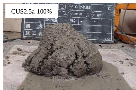
写真-1 タンピング試験状況
