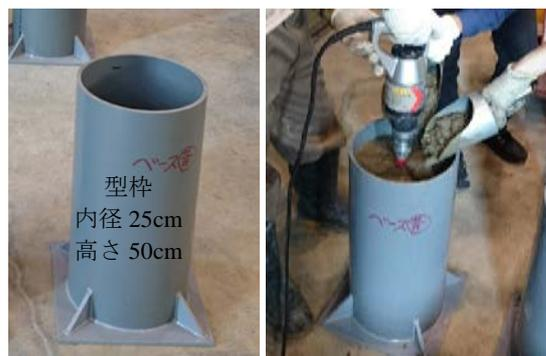
図-1 型枠と締固め状況
