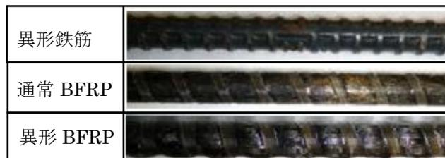
図-3 各補強ロッドの表面形状
