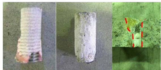
(a) 凝集破壊 (b) 接着破壊 (c) コーン+付着破壊
