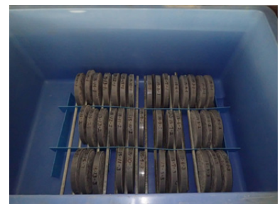
図-2 浸せき試験時の試験片設置状況
