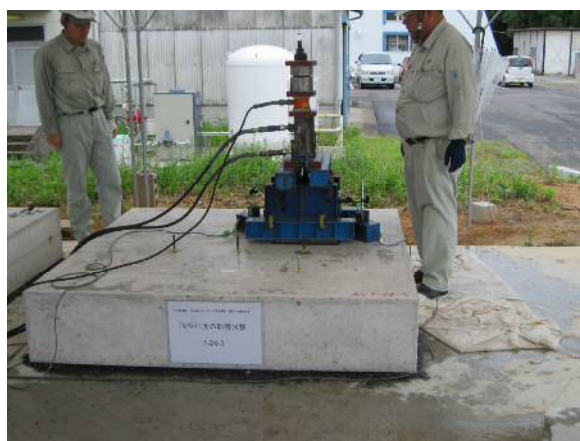
写真-1 引張試験状況
