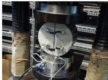
図-1 ひび割れ導入状況
