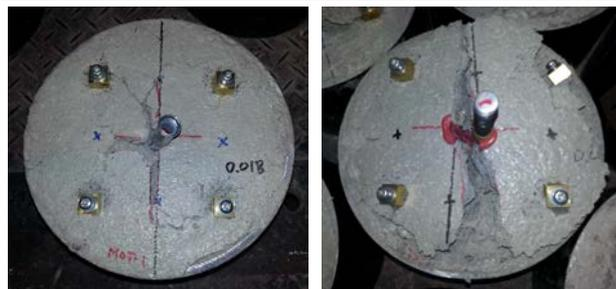
図-3 破壊状況 (左: 金属系, 右: 接着系)
