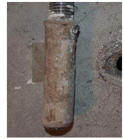
(b)一貫した破壊面の例
