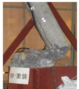
写真-4 PC 電柱の損傷
