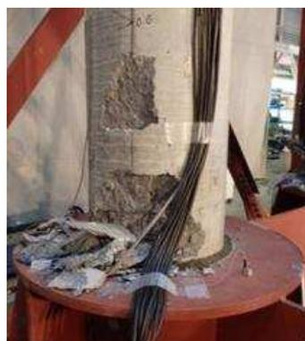
写真-3 PRC 電柱の損傷
