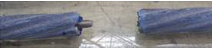
図-3 引張破断後試験体
