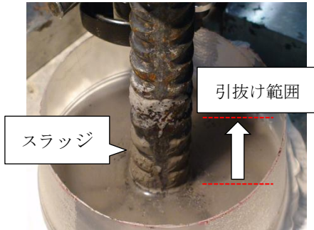
写真 3 引抜け破壊(S1)
