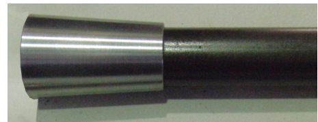
(b) PC 鋼棒にテーパナットをセットした状況 写真-1 PC 鋼棒を用いたアンカー筋の外観
