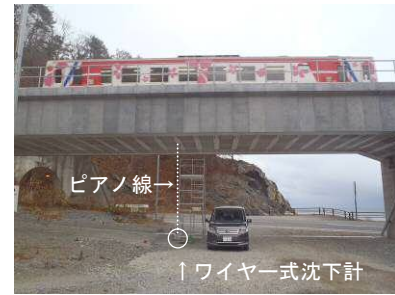
写真-2 ワイヤー式計測状況
