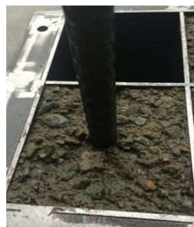
図-8 鉄筋挿入後
