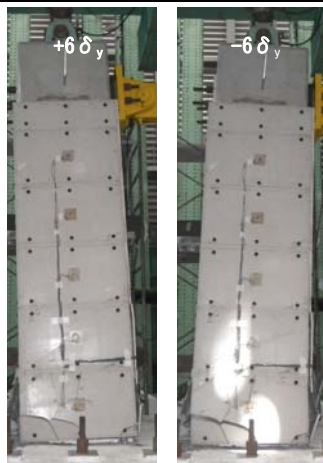
写真3 損傷状況 (No.2)
