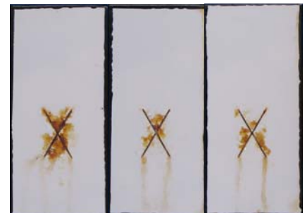
図4 サイクル腐食試験後の人工傷を付けた試験片
