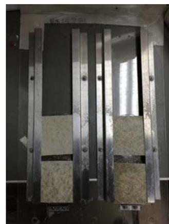
図-4 吸着材料の設置方法
