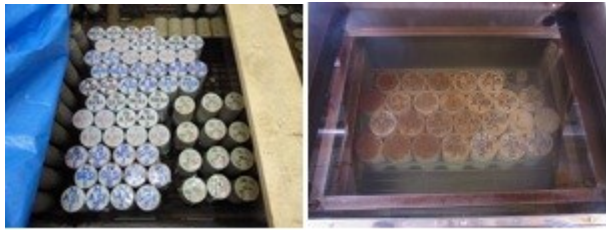
図-2 試験状況(左:浸漬 右:乾湿)
