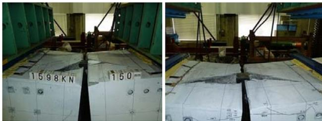
図8 鋼材の損傷状況(左: F-WF, 右: F-NF)
