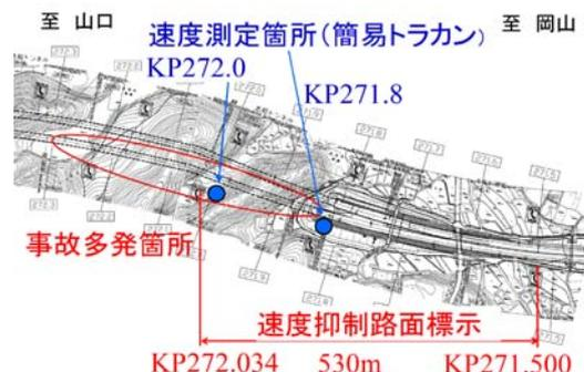
図5 速度抑制路面標示工 対策平面図(志和トンネル)
