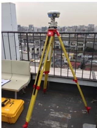
写真-3 屋上 GNSS 基準点測量
