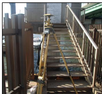
写真-1 GNSS測量
