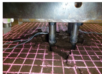
写真-1 杭周辺地盤の損壊状況
