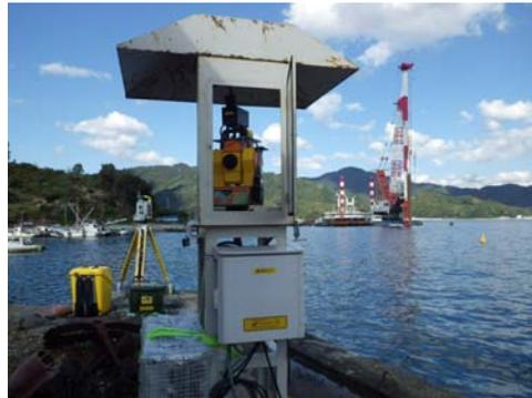
写真-3 (手前) 望遠カメラ搭載型トランシット
