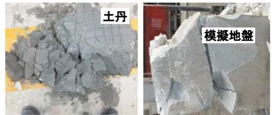
写真-2 土丹と模擬地盤の破壊状況
