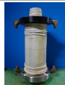
写真-1 粘土供試体 写真-2 ゴムスリーブと
