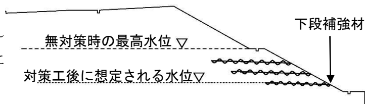
図-4 本工法施工後に想定される水位
