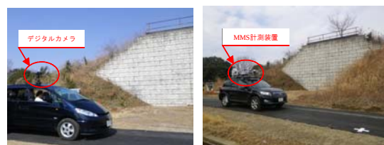
写真-1 走行車両による点検手法の適用性の検討 3)
