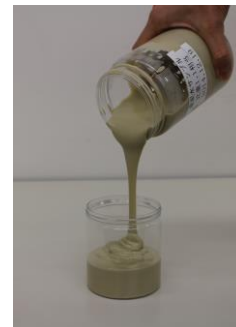
図-1 重泥水の様子
