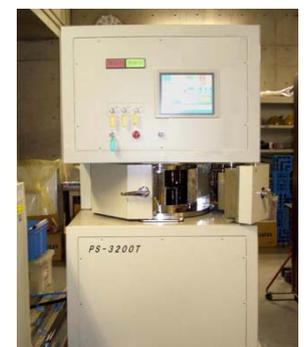
図-3.ガンマ線照射装置
